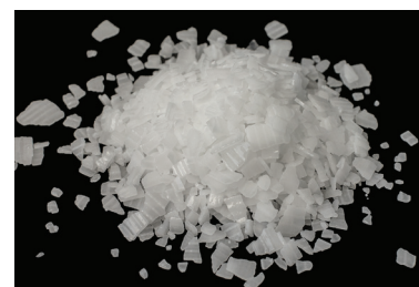
Hidróxido de sódio, em contato com a atmosfera, tem o poder de absorver o vapor de água (material higroscópico).
